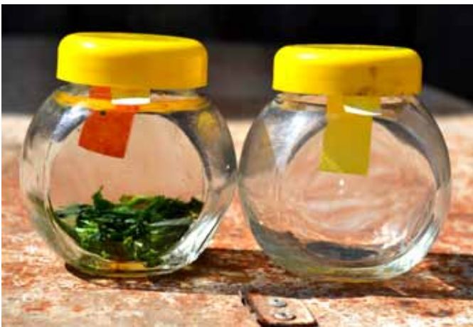
Fig.4. Teste do papel picrossódico em amostra de capim-sudão do local onde ocorreu a intoxicação. O aparecimento da cor vermelho-tijolo no papel do frasco à esquerda revela a presença de ácido cianídrico. No frasco à direita, o papel está na cor original amarela.
